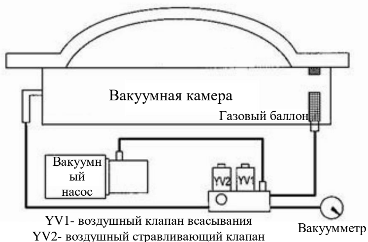
Схема вакуумного упаковщика с производительностью вакуумного насоса 10 \text{ м}^3
