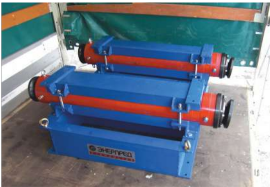
ЦС200Г1250Ш в составе установки для прокола грунта
