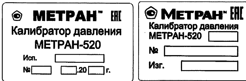
Рисунок 2 – Место нанесения знака утверждения типа и заводского номера
