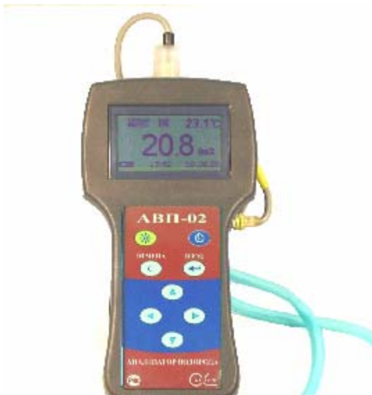
Рис. 2.1. Внешний вид анализатора АВП-02Л.
