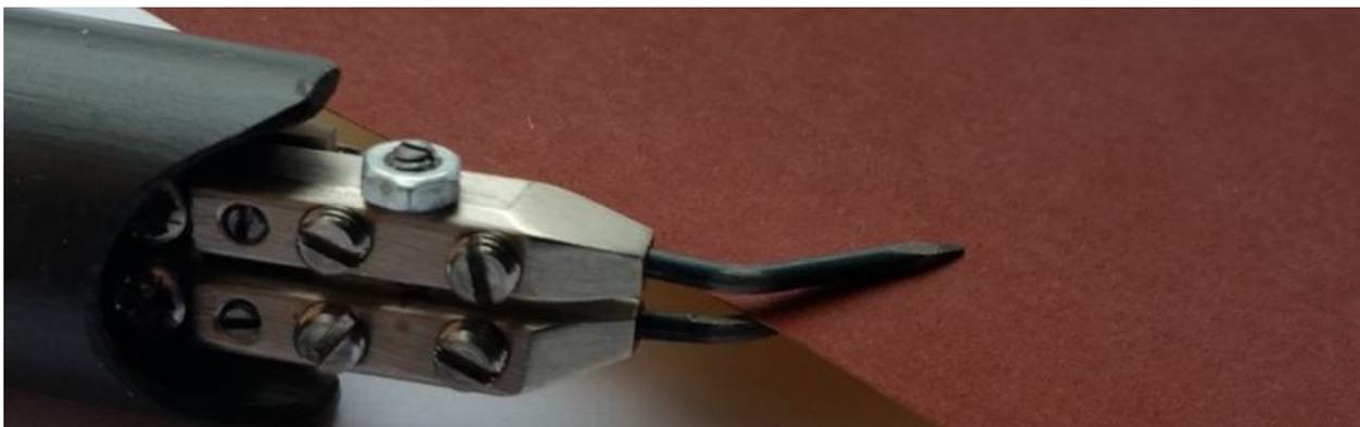
Рис. 2 Заточка внутренней поверхности электродов (Вариант №1)
