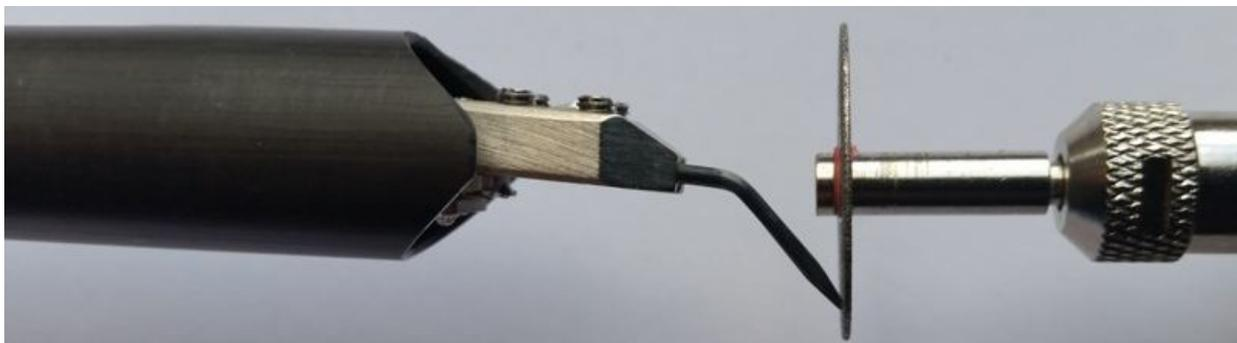
Рис. 5 Заточка передней и задней поверхности электродов
