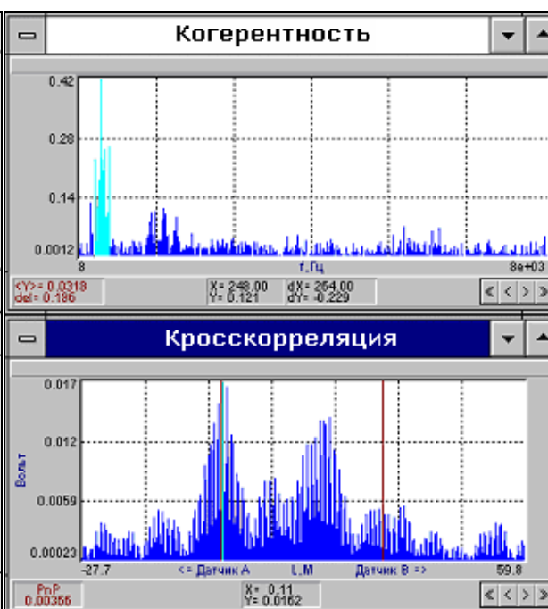
Рис.57. Определение места 2-й утечки за датчиком А, установлен напротив ж/дома 330.
