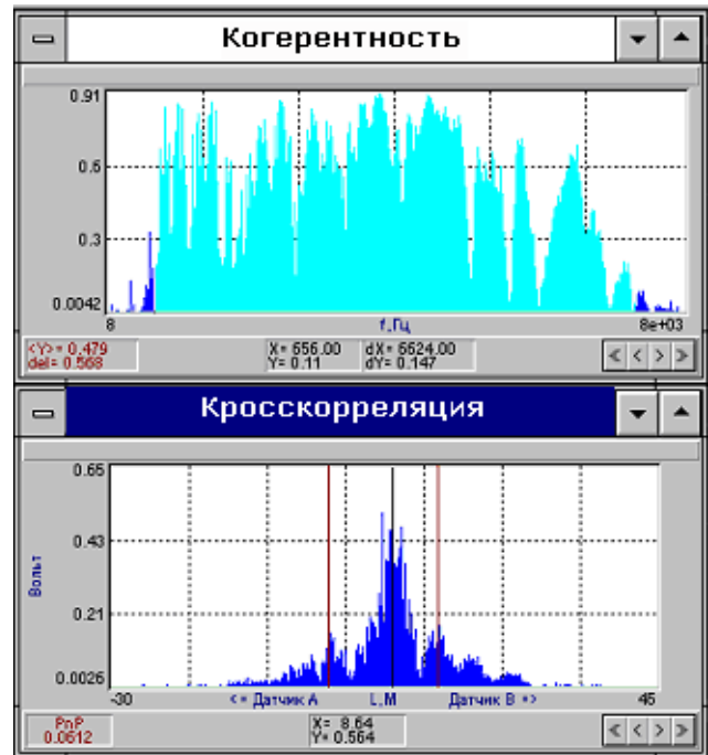
Рис.51 Функции когерентности и кросс корреляции при проверке отводных сегментов (рис.48).
