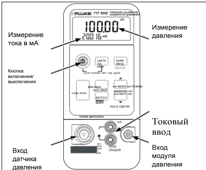
Рисунок 2. Калибратор давления (Модель 717 100G)
