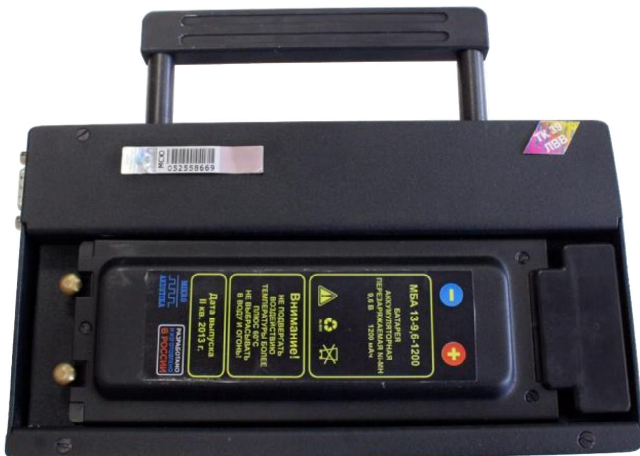
Примечание: место пломбировки модуля для защиты от несанкционированного доступа и место размещения поверительного клейма в виде наклейки находятся на поверхности пульта управления модуля, противоположной лицевой.
