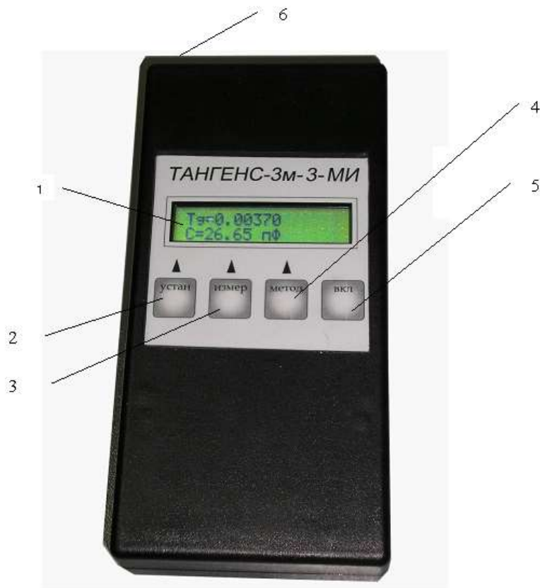
Рисунок 4. Модуль индикации «ТАНГЕНС-3М-3-МИ»:
