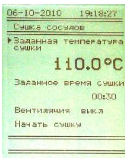
Рис. 11. Вид экрана индикатора в режиме «СУШКА».
