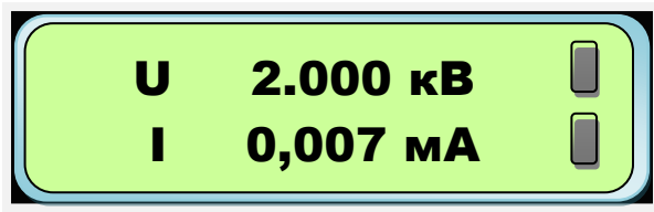
Рисунок 9. Вид экрана модуля индикации «ТАНГЕНС-3М-3-МИ» в режиме измерения напряжения и тока.
