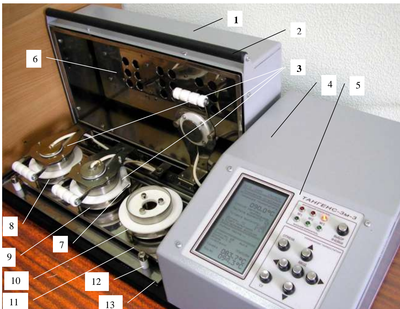
Рисунок 2. Блок основной «ТАН-БО». Внешний вид с открытой крышкой.
