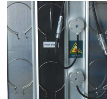
Четыре датчика контролируют излучение в UVV
