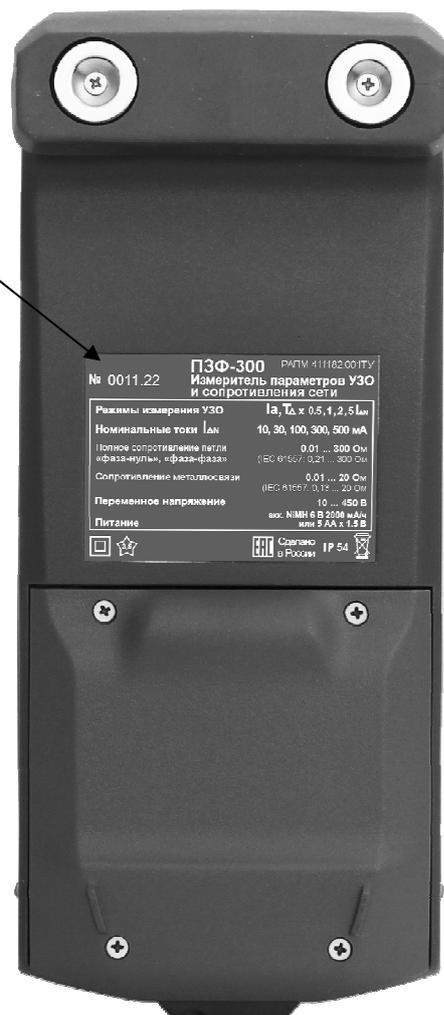
Рисунок 2 – Общий вид измерителей параметров УЗО и сопротивления сети ПЗФ-300. Вид сзади
