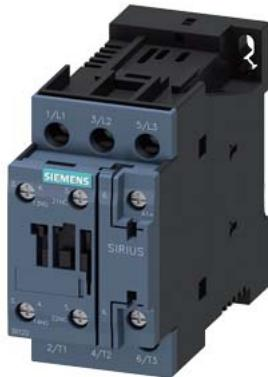
Силовой контактор, AC-3 25 A, 11 кВт/400 В 1 НО + 1 НЗ, 24 В DC 3-полюсн., типоразмер S0 винтовой зажим
