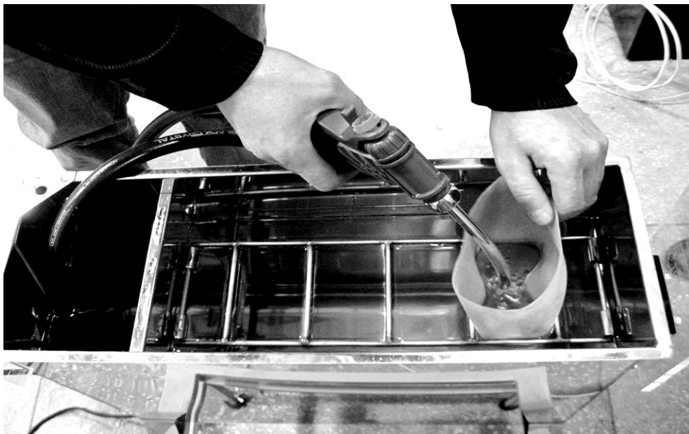
Рис. 8.12. Заполнение перчаток водой.
